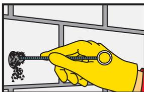
3. El orificio debe limpiarse a fondo con el cepillo de acero especial (cepillo al menos 2x). El diámetro del cepillo debe ser mayor que el diámetro del orificio de perforación
